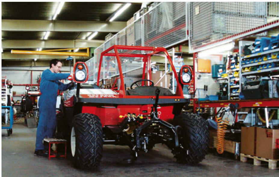
Le «Metrac» peu avant son achèvement: le concept de plate-forme permet de prendre en compte les souhaits spécifiques des clients pour des coûts de fabrication économiques.
