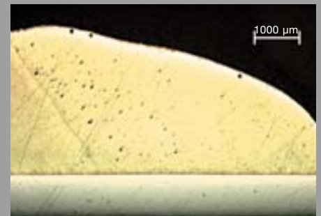
Jointage CMT de l'acier et de l'aluminium. Soudage côté aluminium, brasage côté acier.
