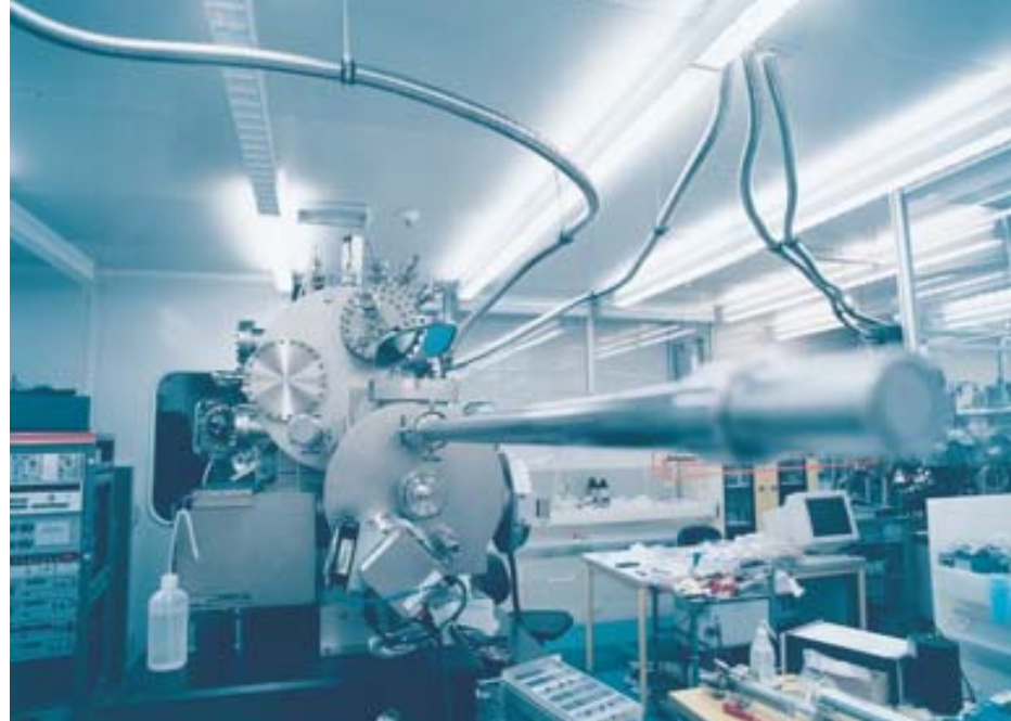
Installation d'épitaxie en salle blanche à l'Institut de Physique du solide et des semi-conducteurs à l'Université Johannes Kepler de Linz. Elle permet d'extraire des hétérostructures semi-conductrices à la précision d'une couche atomique.
