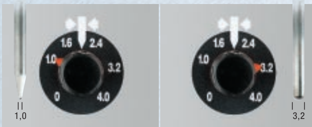
Formation automatique de calottes activable avec la touche torche
