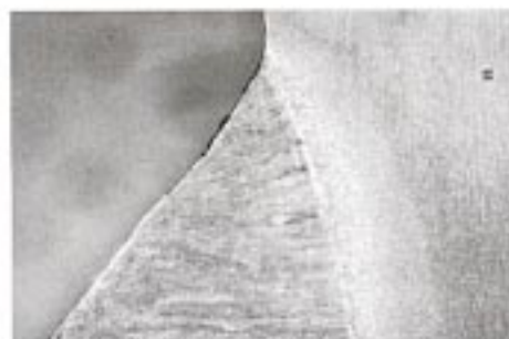
Transition soudure T.I.M.E. / métal de base
