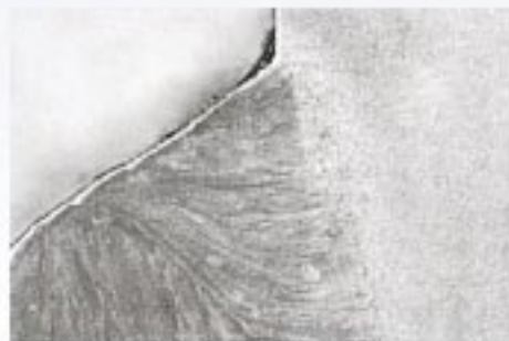
Transition soudure MAG / métal de base
