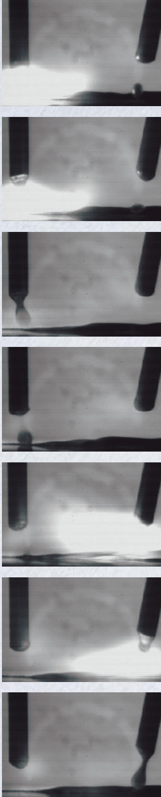
Transfert de matière AISi 5 diamètre du fil 1,2mm
