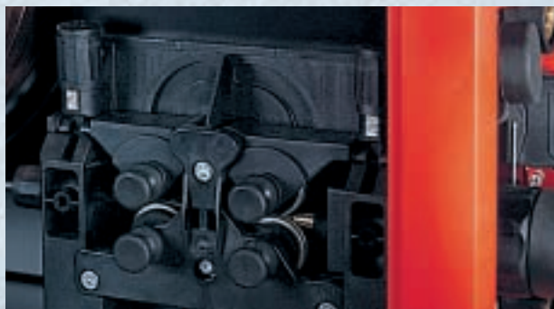
Entraînement à 4 galets intégré à la source de soudage pour un transport précis et fiable du fil d'apport
